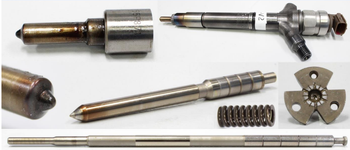
Abbildung 8: Fotodokumentation Injektor Versuchslauf 1: Dieselmkraftstoff ohne Performance-Additive
