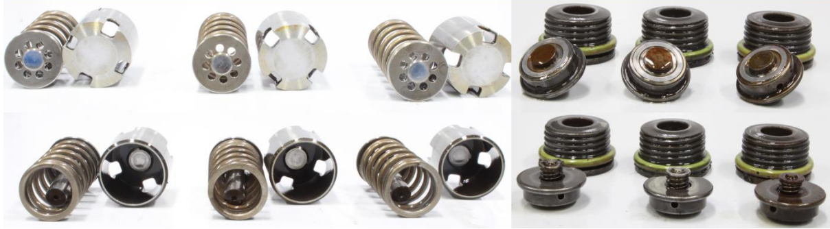
Abbildung 7: Fotodokumentation HDP Versuchslauf 1: Dieselmkraftstoff ohne Performance-Additive
