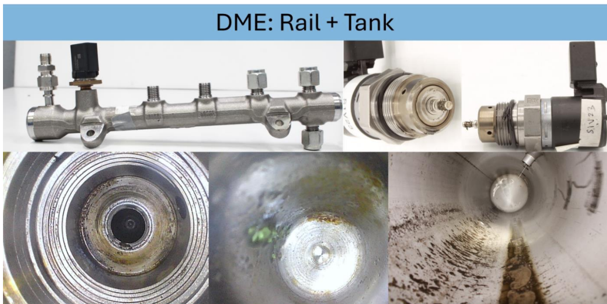
Abbildung 14: Fotodokumentation Rail und Tank Versuchslauf 2: reines DME
