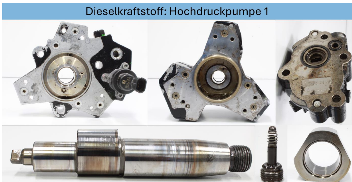
Abbildung 6: Fotodokumentation HDP Versuchslauf 1: Dieselkraftstoff ohne Performance-Additive
