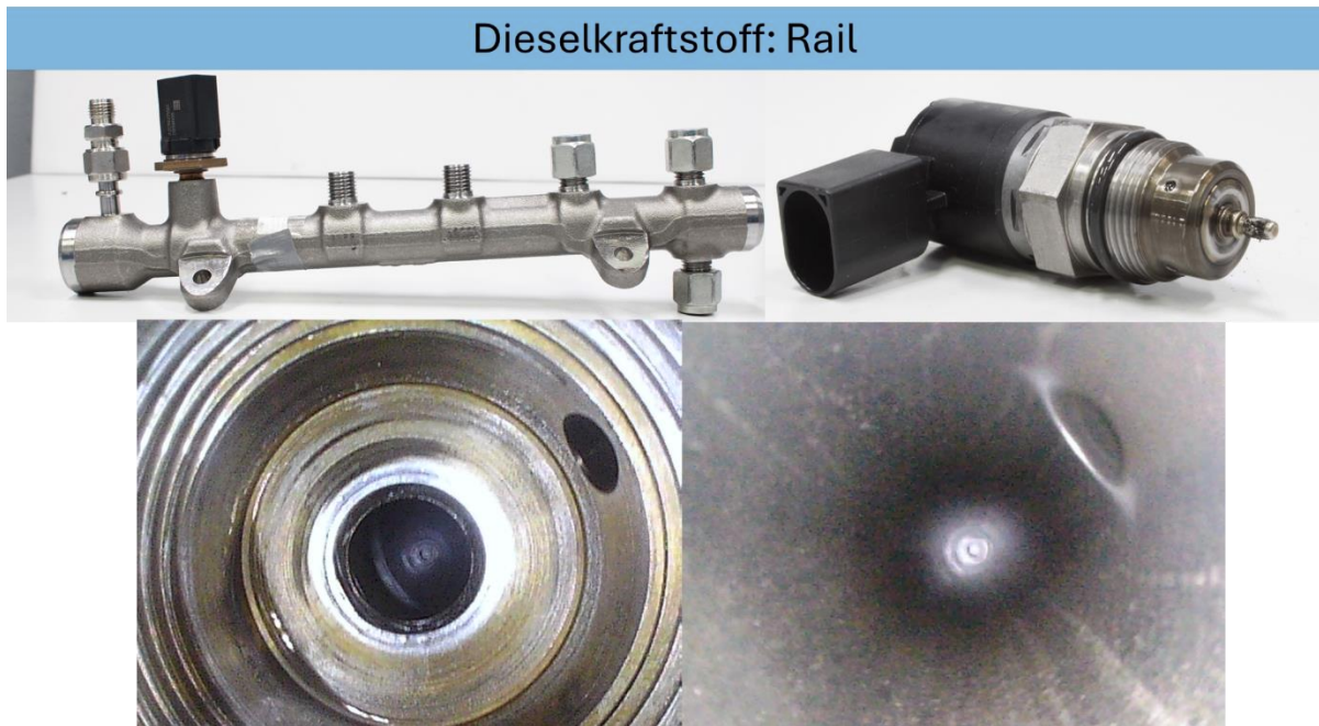
Abbildung 9: Fotodokumentation Rail Versuchslauf 1: Dieselkraftstoff ohne Performance-Additive
