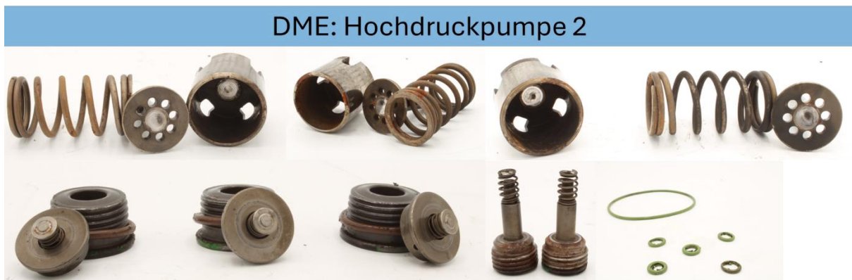
Abbildung 12: Fotodokumentation HDP Versuchslauf 2: reines DME
