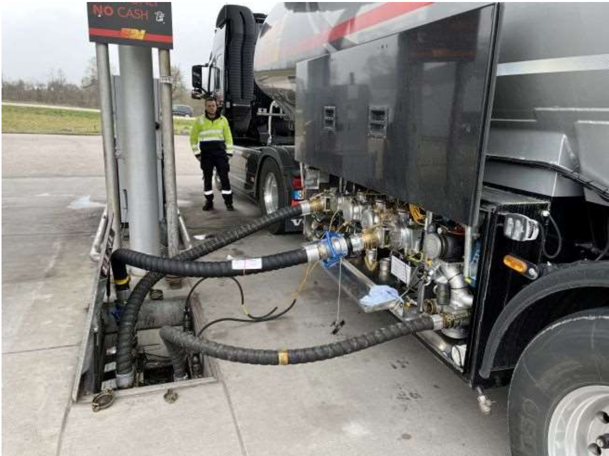
Erfolgreich verlaufende Betankung mit Trockenkupplungen und Adaptern zwischen TW-Kupplungen und Trockenkupplungen.
